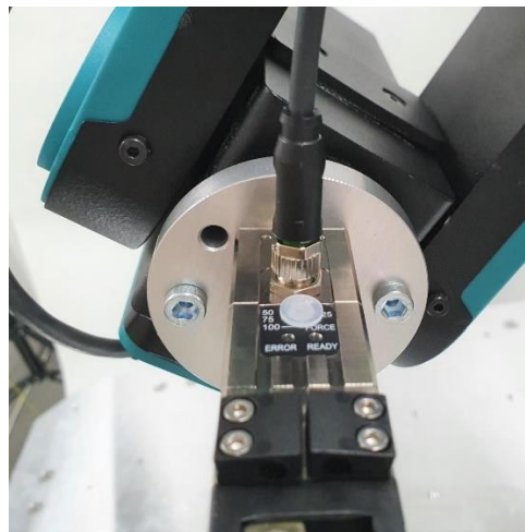
Abbildung 9: Greifer am Roboterflansch
