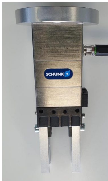
Abbildung 7: Grundgerät mit Greiferbacken
