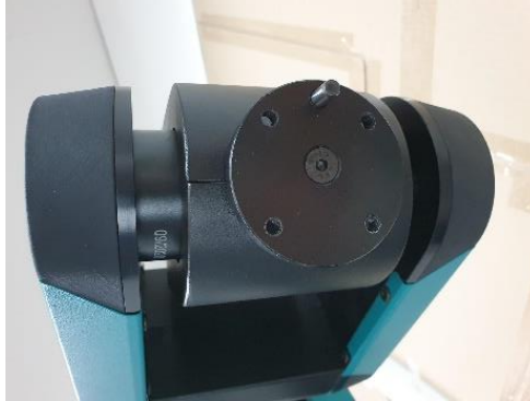
Abbildung 8: Zentrierbolzen in Roboterflansch
