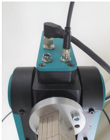
Abbildung 11: Anschluss Elektrik an Roboter
