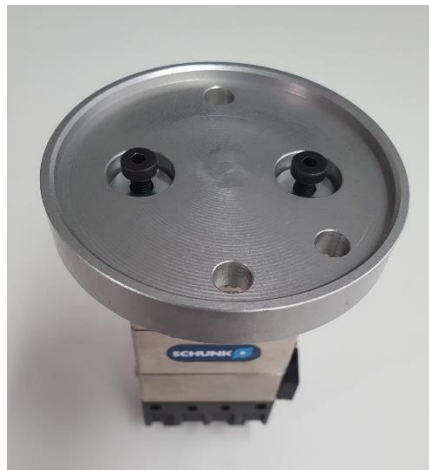
Abbildung 5: Adapterplatte auf Zentrierhülsen
